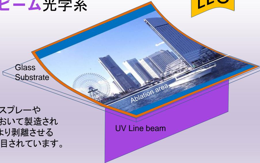
近年フレキシブルのフラットパネルディスプレイや大型ウエハ上での半導体プロセスにおいて製造されたデバイスを基板の裏からレーザーにより剥離させるレーザーリフトオフ・プロセス(LLO)が注目されています。
